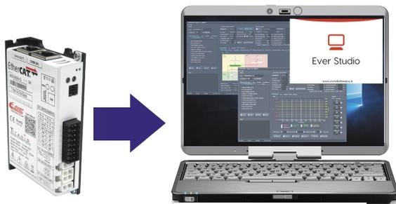
Seriale di servizio SCI, per la configurazione ed il debug in real time, senza interrompere il lavoro dell'azionamento e del PLC.
